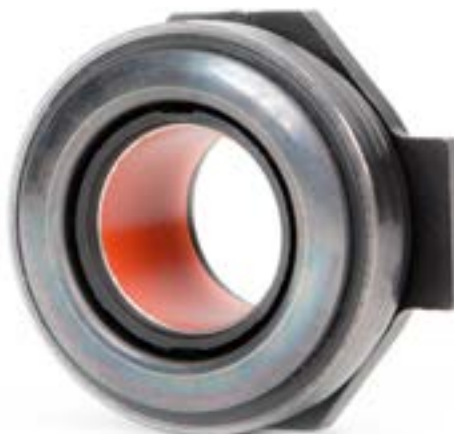
Рис. 3: Выжимные подшипники с втулками из PTFE не должны смазываться
